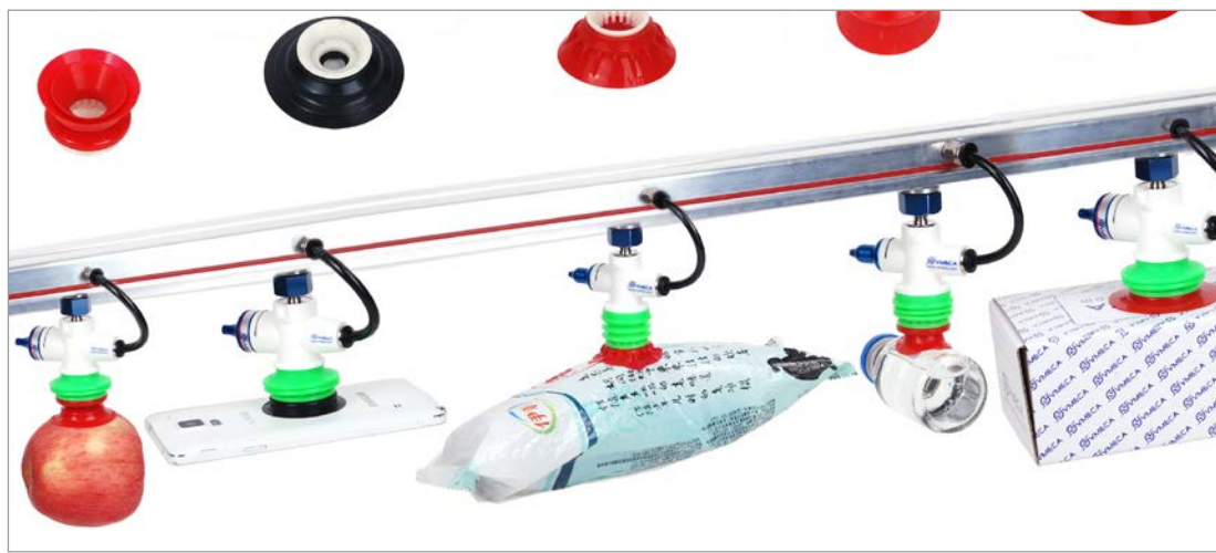
De Magic-Gripper kan allerlei objecten makkelijk vastgrijpen
